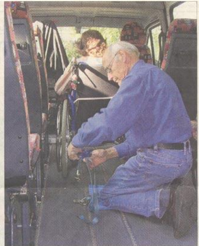
Zuerst befördert Arthur Helbling die Frau im Rollstuhl mit der Hebebühne ins Auto. Danach muss ihr «Gefährt» an der Bodenschiene verankert werden. (Camilla Traxel-Bacchi)
